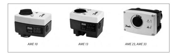
Электроприводы предназначены для работы с регулирующими клапанами VS2, VM2, VFM2. Приводы управляются аналоговым сигналом типа Y. Существуют варианты данного электропривода с защитной функцией. Устройство защиты (возвратная пружина) позволяет закрыть регулирующий клапан при обесточивании системы.
